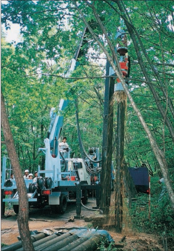
水井戸 SGP管を使用して100m程度(最大250m)の水井戸掘削に使用されています。
